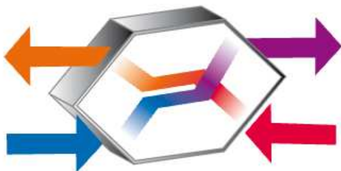
Intercanviador. Font: solerpalau.es
