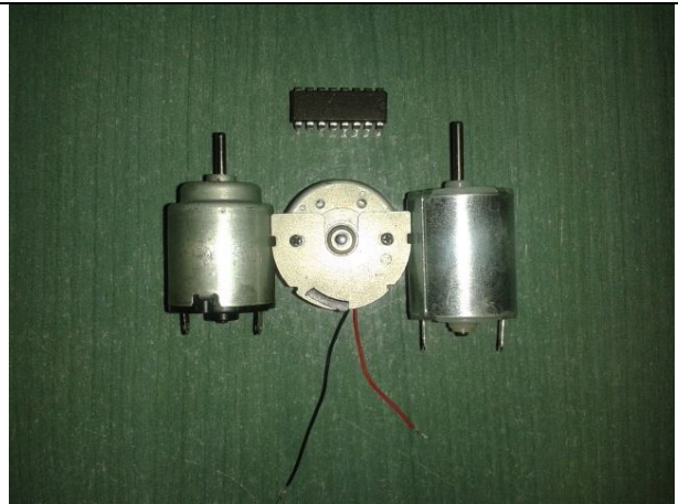
Motors per les persianes i pont H (L293D)
